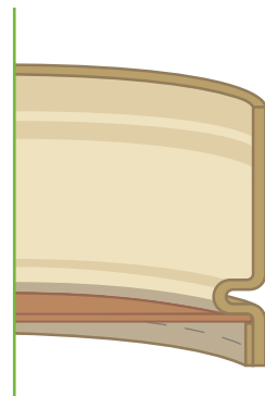
MDF-Boden formschlüssig zwischen Sicke und Stoß-Pappring geklemmt und geheftet
